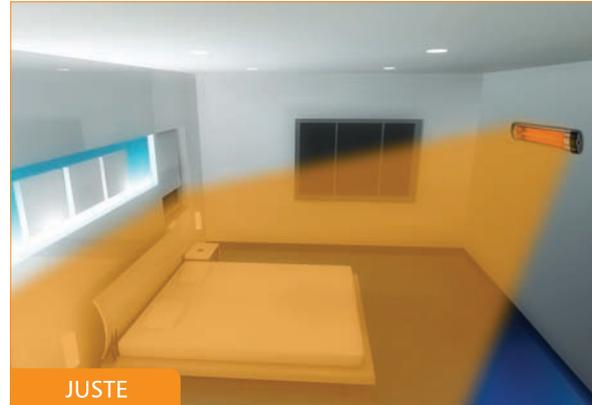
Pour optimiser l'utilisation de votre chauffage UFO dans votre chambre à coucher, installez-le face à vous pour avoir un chauffage plus homogène.
